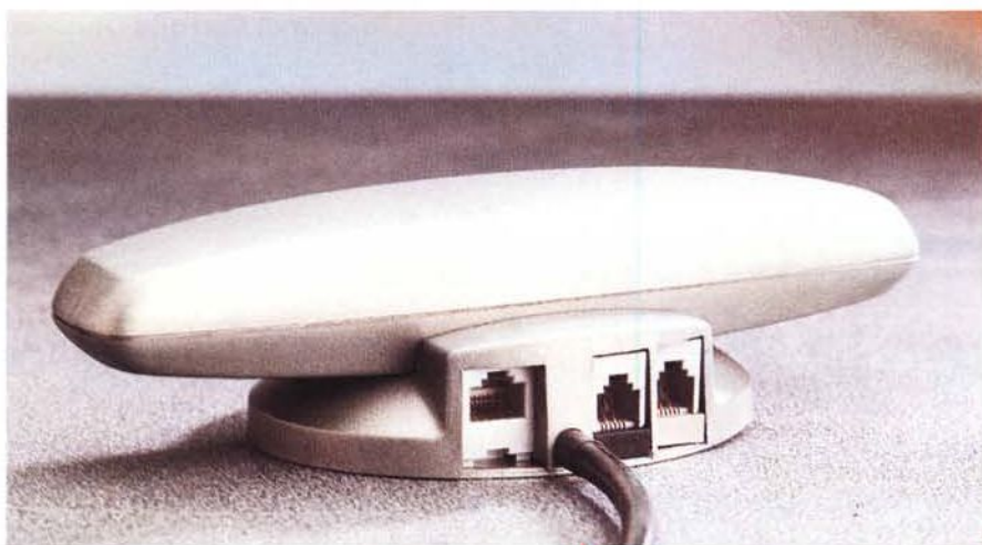
Il collegamento elettrico tra le varie unità avviene attraverso connettori di tipo plug-in di diverso colore/dimensione. Nella foto in alto a destra un dettaglio sul ricevitore IR incorporato nel casco.
